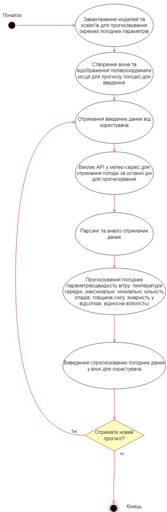
Рисунок 3.2 – Схема функціонування програмного забезпечення для прогнозування погодних характеристик
