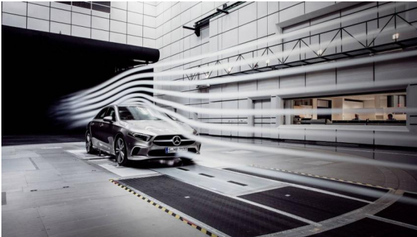
Рисунок 2.4 – Візуалізація методом димових струменів автомобіля Mercedes-Benz
