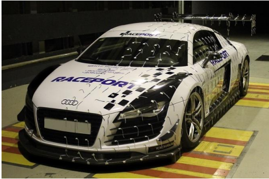
Рисунок 2.3 – Візуалізація повітряного обтікання автомобіля Audi шовковими нитками
