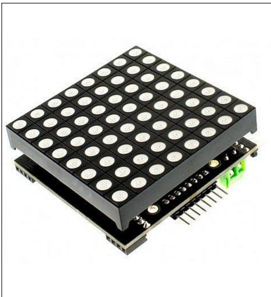
Рисунок 2.1 – Зовнішній вигляд кристала світлодіодної матриці
