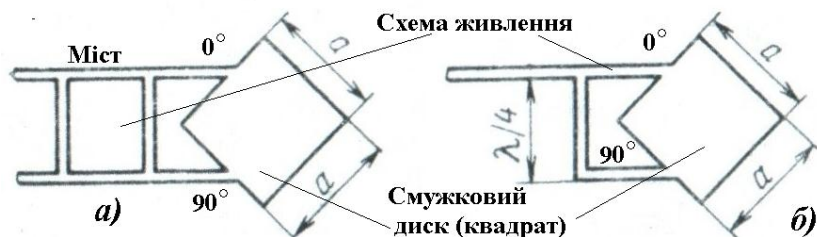
Рисунок 11.22 – Схеми збудження поля з круговою поляризацією
