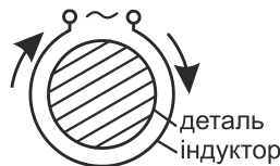
Рисунок 2.57 – Схема гартування з нагріванням СВЧ
