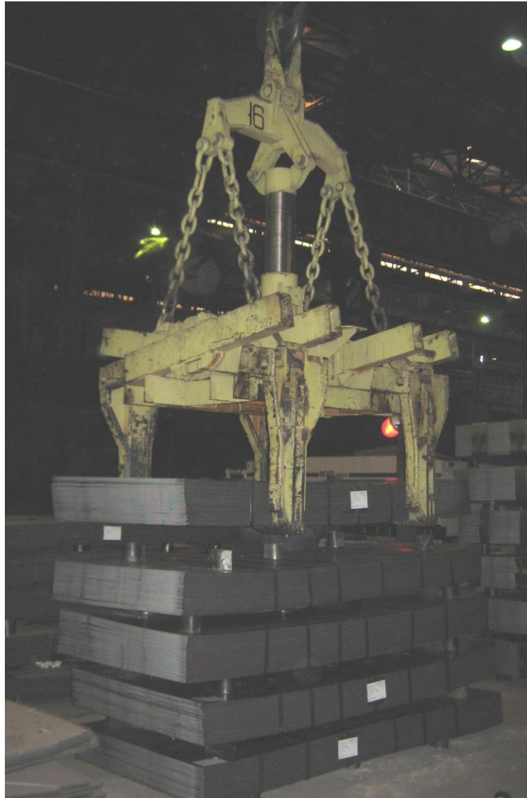
Рисунок 1.9 – Розформування штабелю металопрокату за допомогою траверсного захвату
