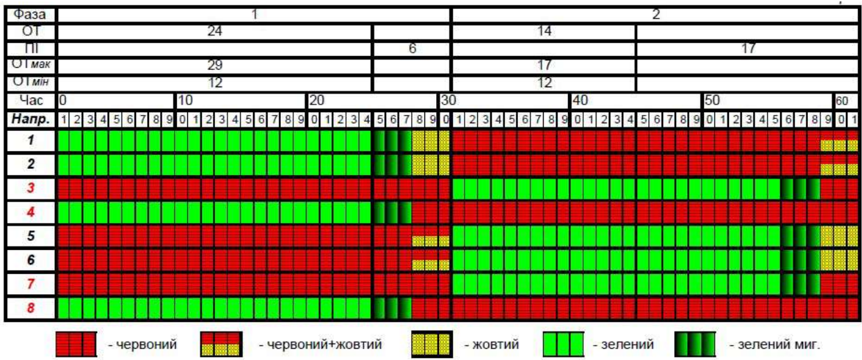
Рисунок 1.18 – Циклограма роботи світлофорів на перехресті
