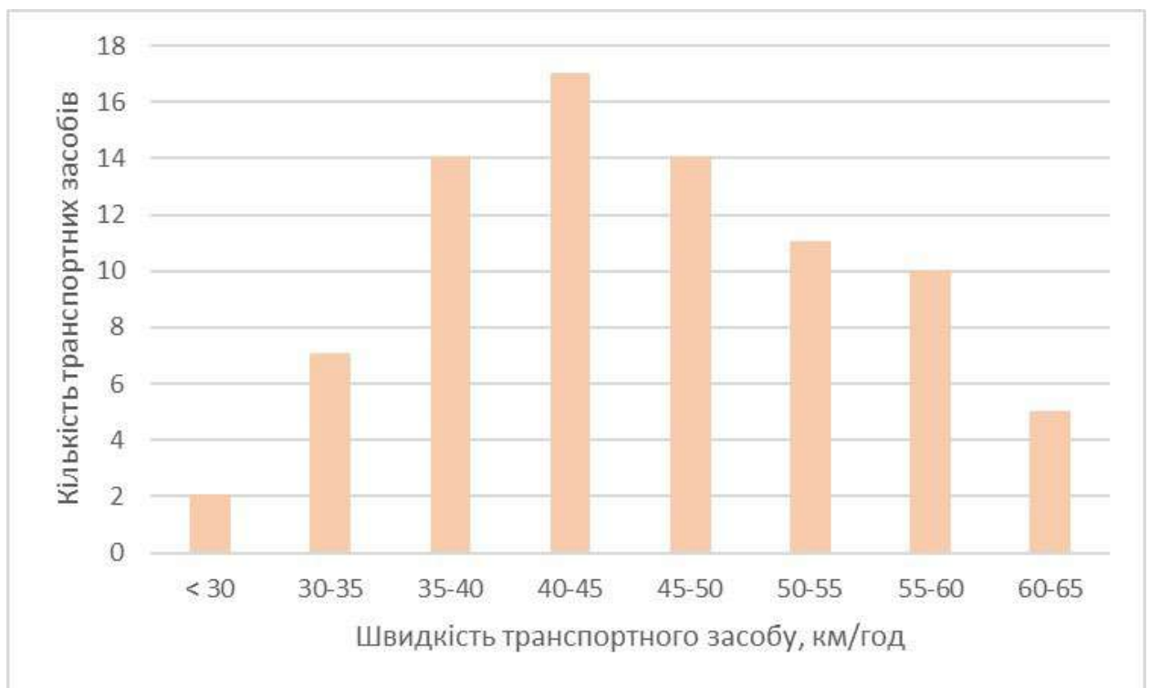
Рисунок 1.15 - Розподіл швидкостей руху на підході до перехрестя проспектом Ювілейним з боку проспекту Преображенського
