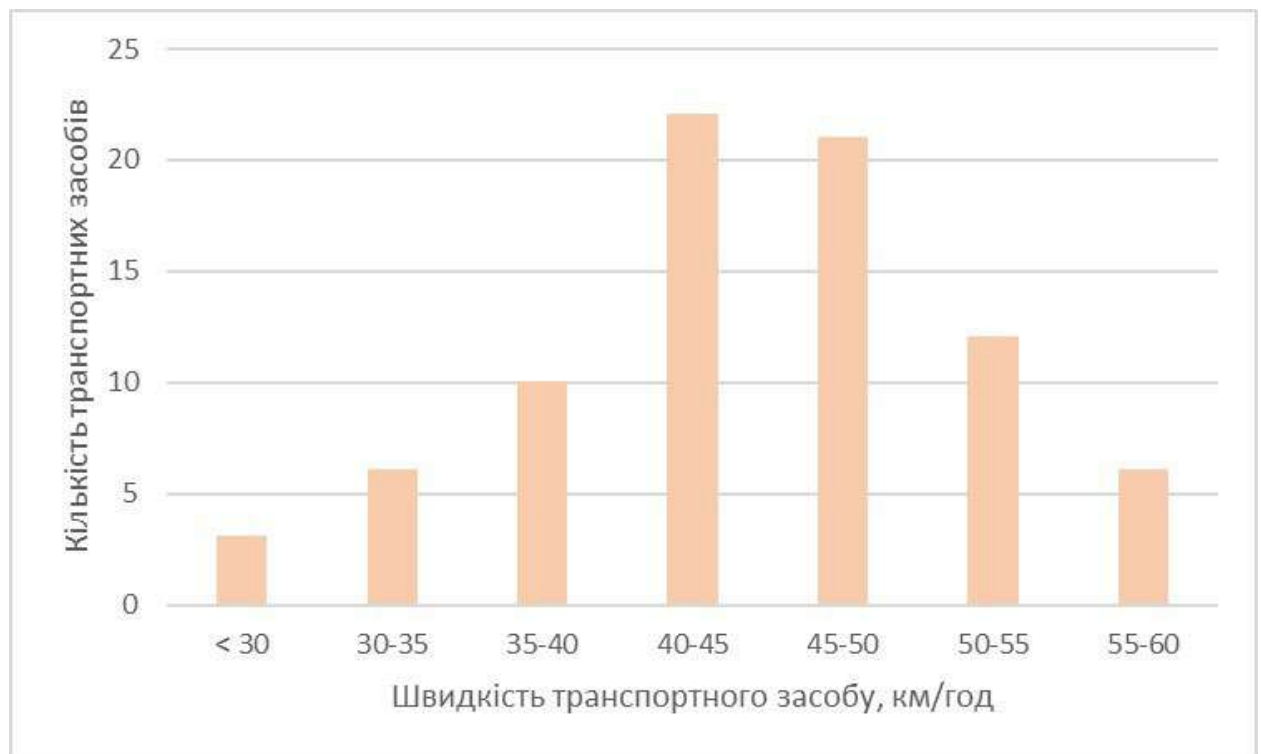
Рисунок 1.16 - Розподіл швидкостей руху на підході до перехрестя проспектом Ювілейним з боку вулиці Запорізького Козацтва
