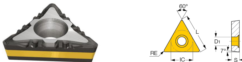
Рисунок 1.10 - Ріжуча пластина TCMT 16T304-F3P
