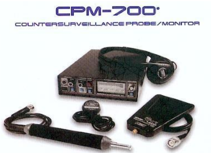
Рисунок 5.1- Комплект CPM-700. На передньому плані зліва – РЧ-зонд
