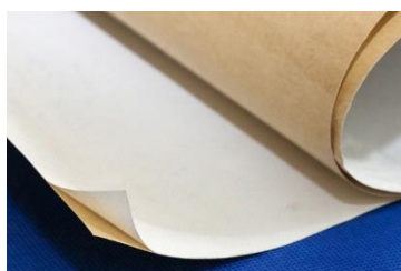
Рисунок 3.1 – фенолокаучукова клейова плівка ВК-50
