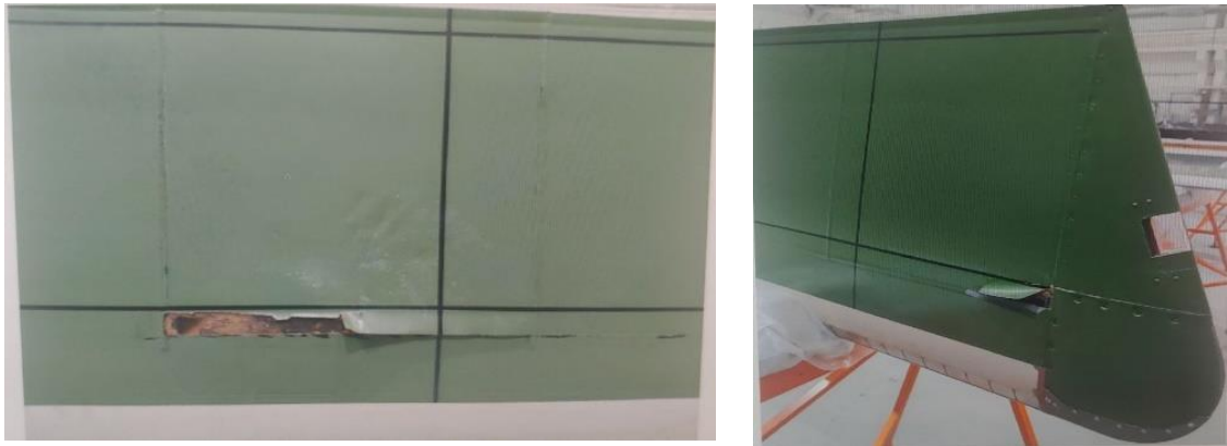
Рисунок 2.3 – Дефекти клейового з'єднання на ЛНГ
