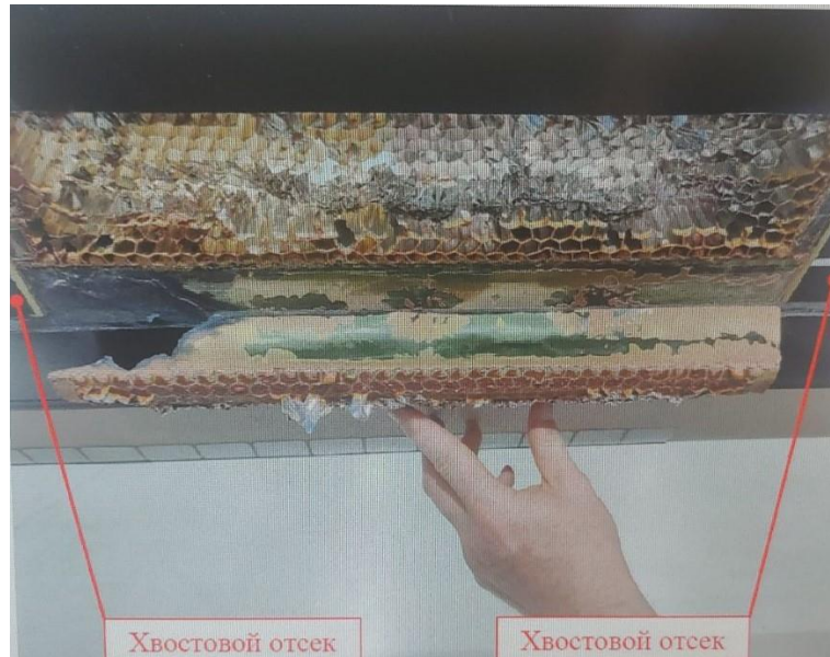
Рисунок 2.8 – Вид зразку після випробування на нерівномірний відрив клейового з'єднання
