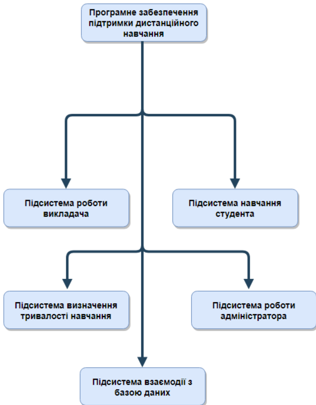
Рисунок 3.3 – Структурна схема програмної системи
