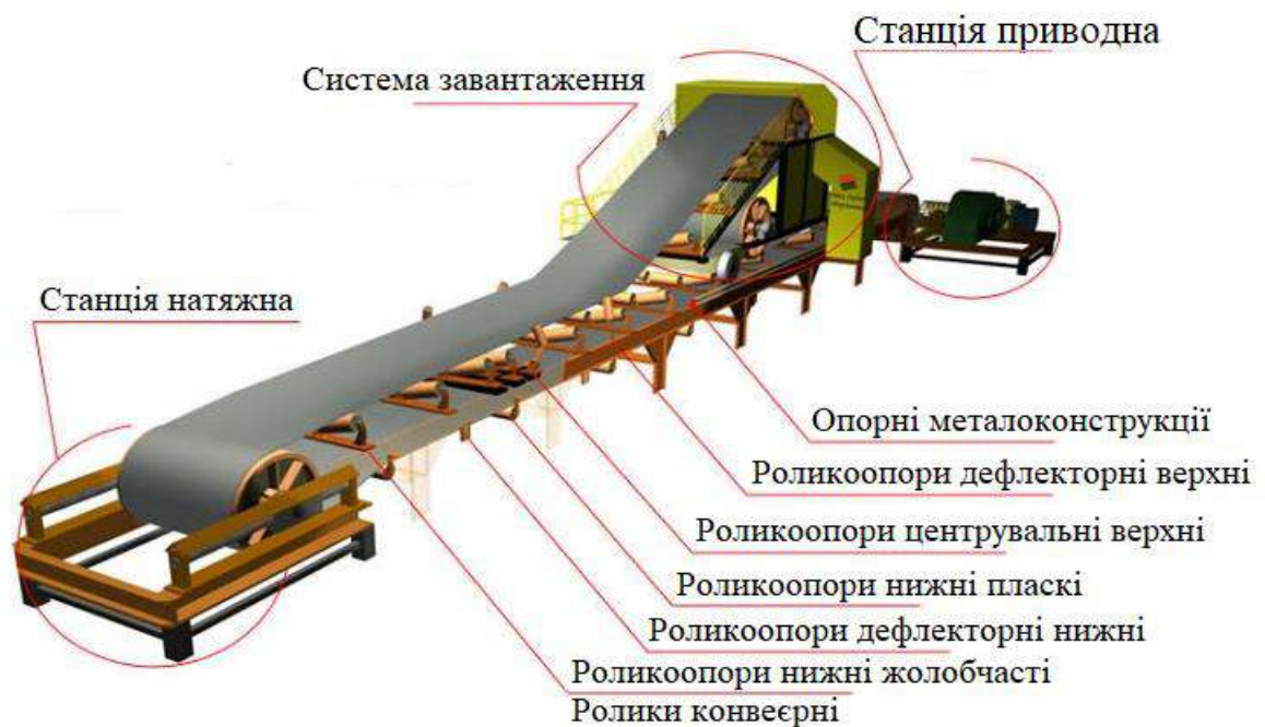
Рисунок 1.3 – Загальна конструкція стрічкового конвеєра
