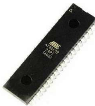
Рисунок 2.4 – Мікроконтролер АТ89С52 (зображення з джерела [15])
