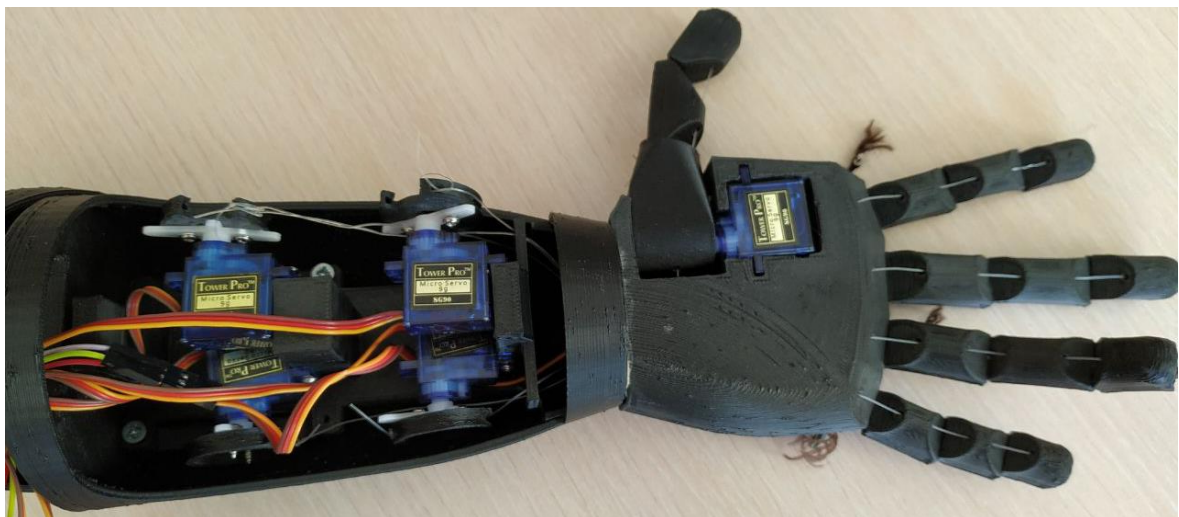
Рисунок 1.22 – Закріплення сервоприводів на РП [51]
