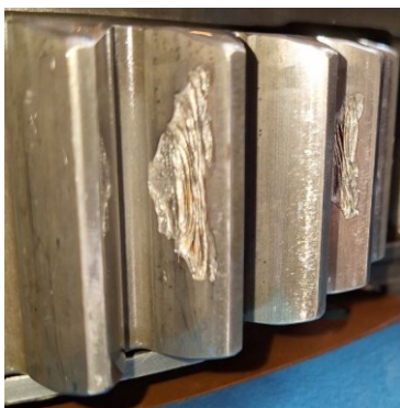
Рисунок 1 – Викришування зубів зубчастого колеса авіаційного редуктора
