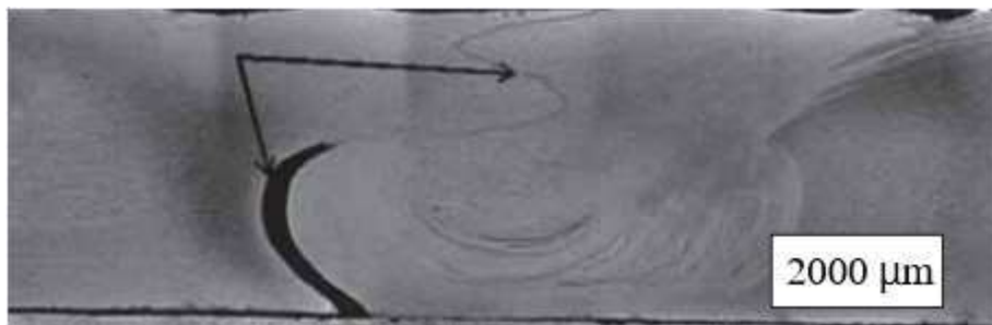
Рисунок 5.5 - Дефект у вигляді лінії стику у шві сплаву АМг6
