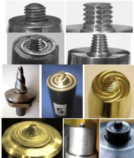
Рисунок 4.11 – Робочі частини інструментів для ЗТП
