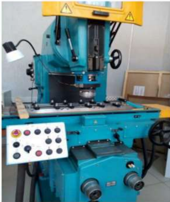
Рисунок 4.1 – Дослідницька установка для зварювання тертям з переміщенням на базі вертикально-фрезерного верстата 6Т12
