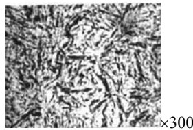
Рисунок 8.1 – Мартенсит відпущений ( M_{\text{відп}} ) в сталі У8 (при друкуванні зменшено в 2 рази)
