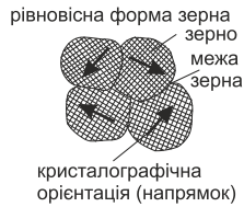
Рисунок 1.15 – Схема, що показує різну орієнтацію кристалічних ґраток в полікристалі
