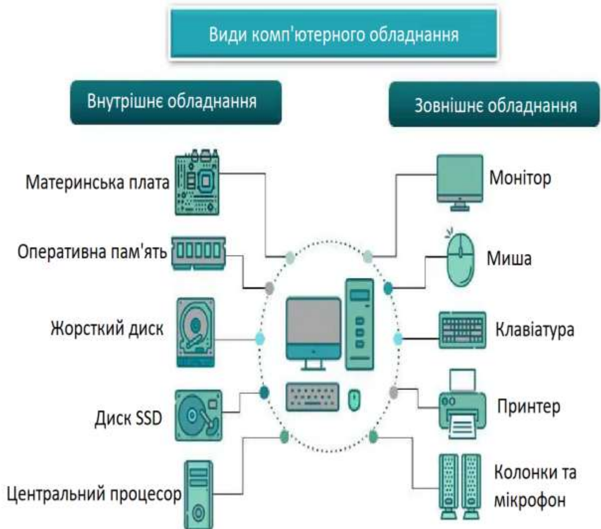
Рисунок 1.1 – Класифікація апаратних складових комп'ютерної техніки [3]
