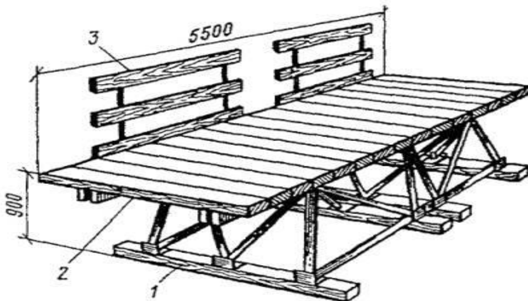
Рисунок 3.1.- Підмостка для другого ярусу кладки
