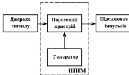
Рисунок 4.34 – Функціональна схема інвертуючого модулятора
