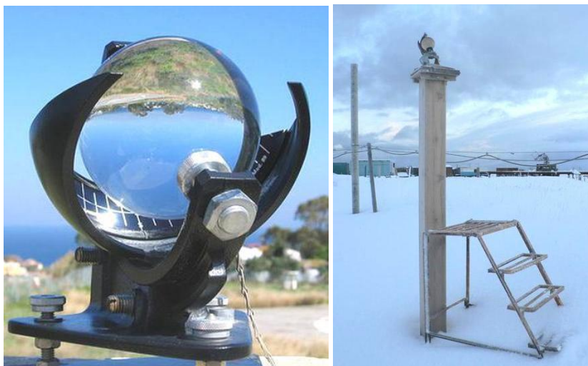
Рисунок 10.3 – Універсальний геліограф Кемпбелла-Стокса ГУ-1 та його кріплення на установці
