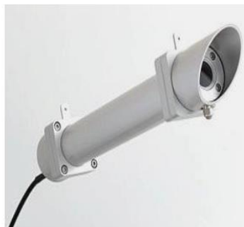
Рисунок 10.1 – Зовнішній вигляд DR01 піргеліометра та піргеліометра фірми Nukseflux
