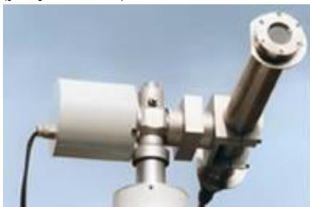
Рисунок 10.1 – Зовнішній вигляд DR01 піргеліометра та піргеліометра фірми Nukseflux
