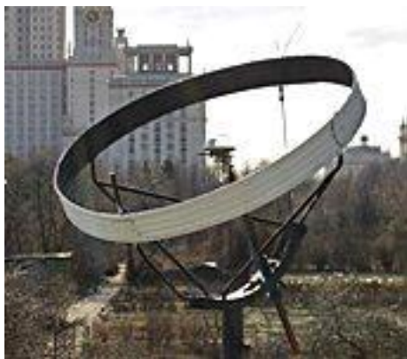
Рисунок 10.10 – Тіньове кільце з піранометром для реєстрації розсіяної радіації
