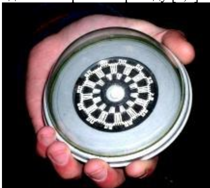
Рисунок 10.14 – Термоелектрична батарея піранометра
