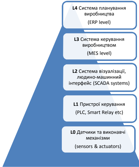
Рисунок 2.2 – Рівні керування виробництвом в моделі Siemens Digital Enterprise
