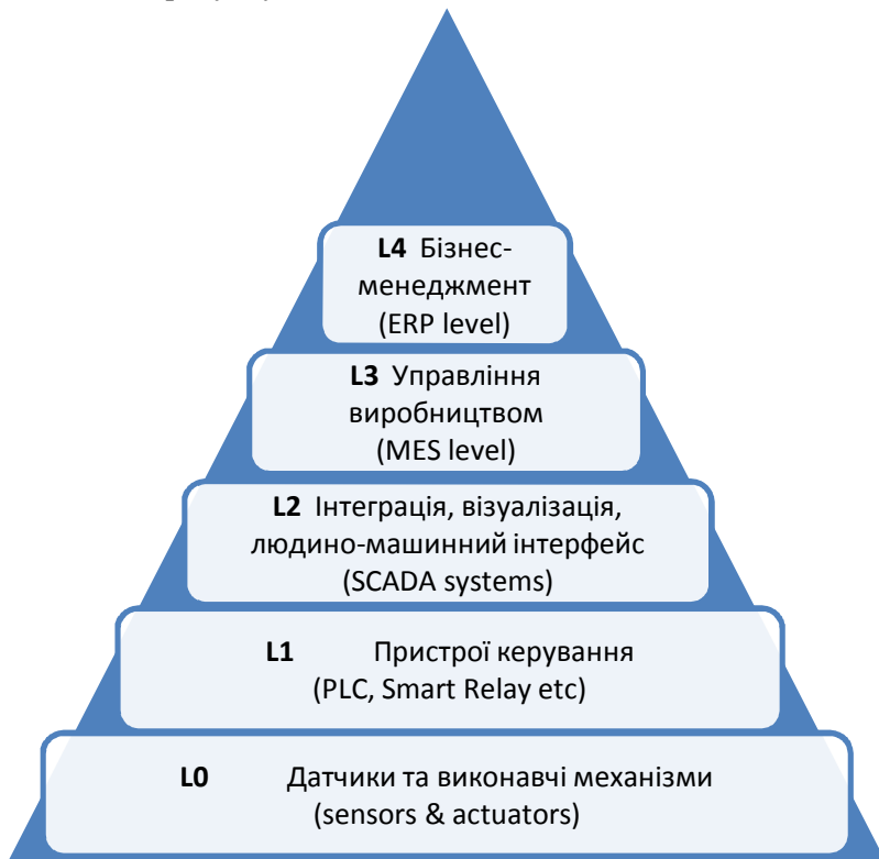
Рисунок 2.5 – Рівні керування виробництвом
