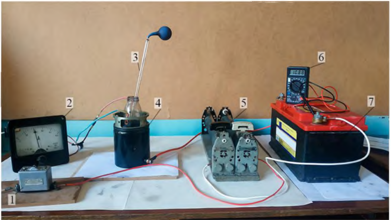
1 – вимикач; 2 – амперметр; 3 - капілярна трубка; 4 – обмотка збудження статора; 5 – реостат; 6 – мультиметр; 7 – акумуляторна батарея
