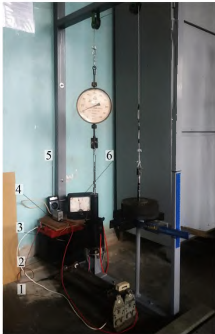
1 – реостат; 2 – обмотка збудження статора; 3 – акумуляторна батарея; 4 – вимикач; 5 – мультиметр; 6 – амперметр
