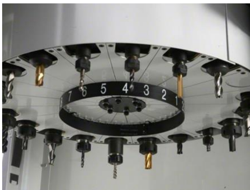
Рисунок 9.2 – 20-позиційна поворотний механізм TC-20
