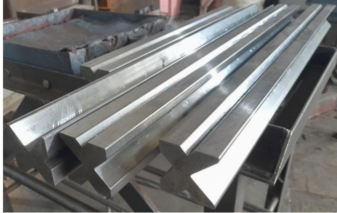
Рисунок 1.5 – Матриці для кутового згинання листів за малим радіусом
