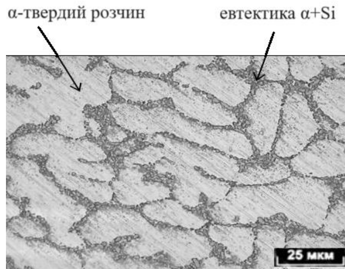
Рисунок 3.1 – Структура сплаву АК7 після гартування з температури 540°С
