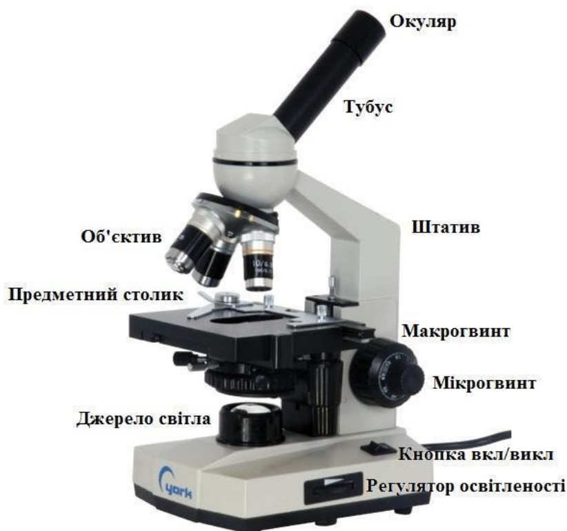
Рисунок 2.2 – Приклад світлового мікроскопу та його компоненти [25]
