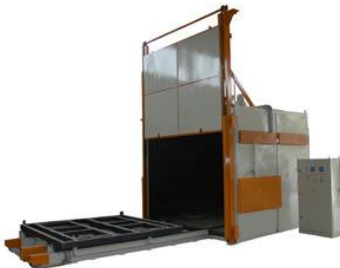
Рисунок 3.6 – Електропід-конвеєр НК 17.17.18/2 ИЗ П
