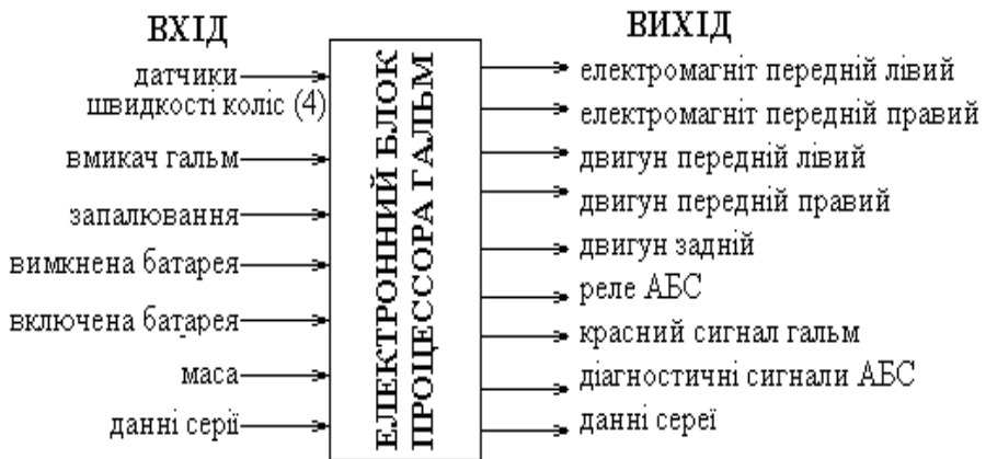
Рисунок 13.15 - Сигнали входу і виходу електронного блоку управління гальмуванням
