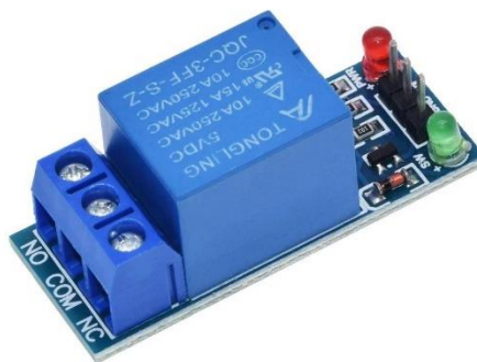
Рисунок 2.18 – Приклад модуля електромеханічного реле на 1 канал з опторозв'язкою 5V - 250V 10A [37]
