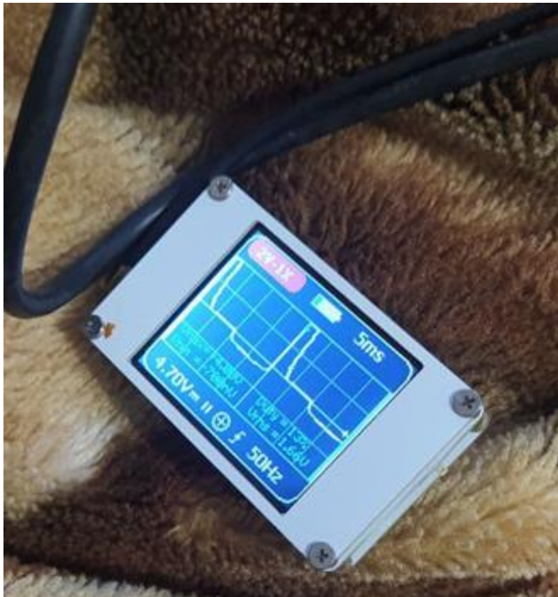
Рисунок 3.16 – Підключення осцилографа в ході тестувань до схеми з датчиком струму
