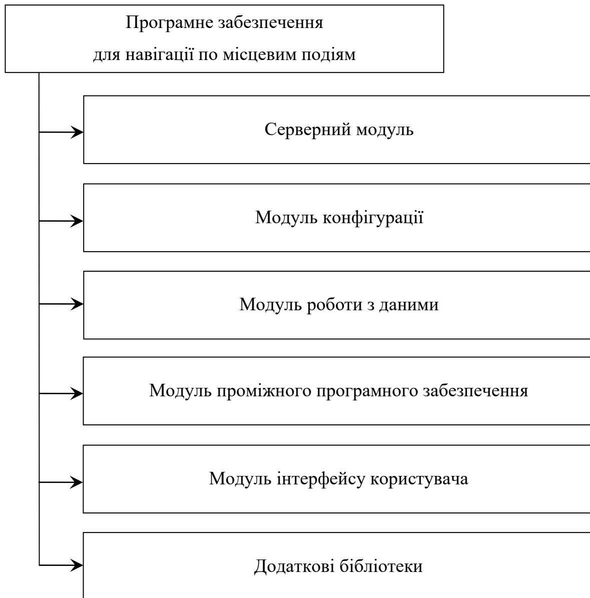
Рисунок 3.1 – Структура програмного забезпечення для навігації по місцевим подіям
