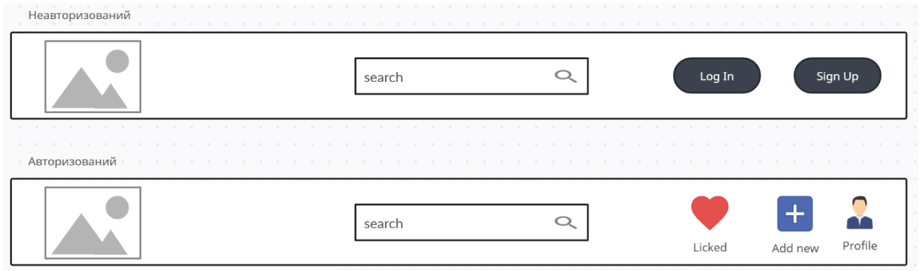
Рисунок 2.22 – Схема розташування елементів у хедері
