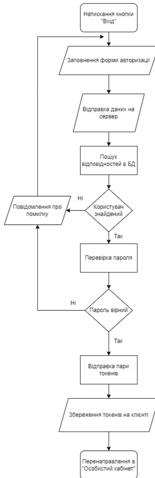
Рисунок 3.4 –Блок-схема процесу авторизації
