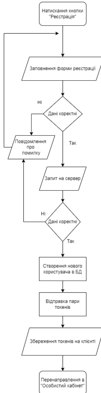
Рисунок 3.3 – Блок-схема процесу реєстрації
