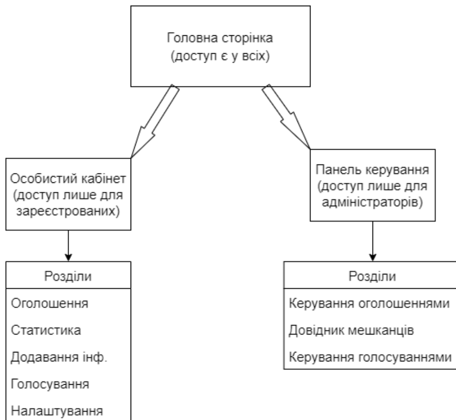
Рисунок 3.1 - Структурна схема клієнтської частини застосунка
