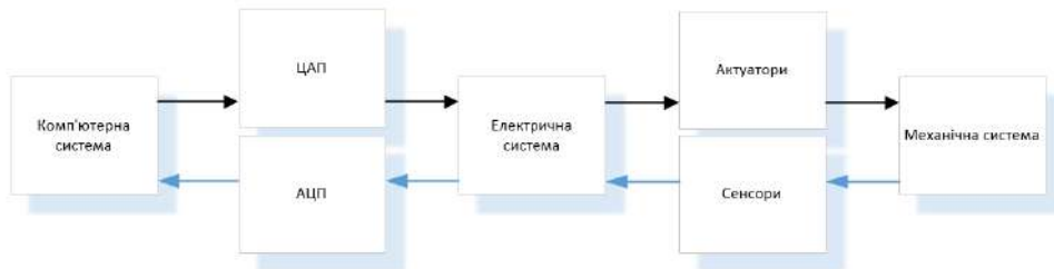
Рисунок 1.1 – Схема потоку сигналу для типової мехатронної системи
