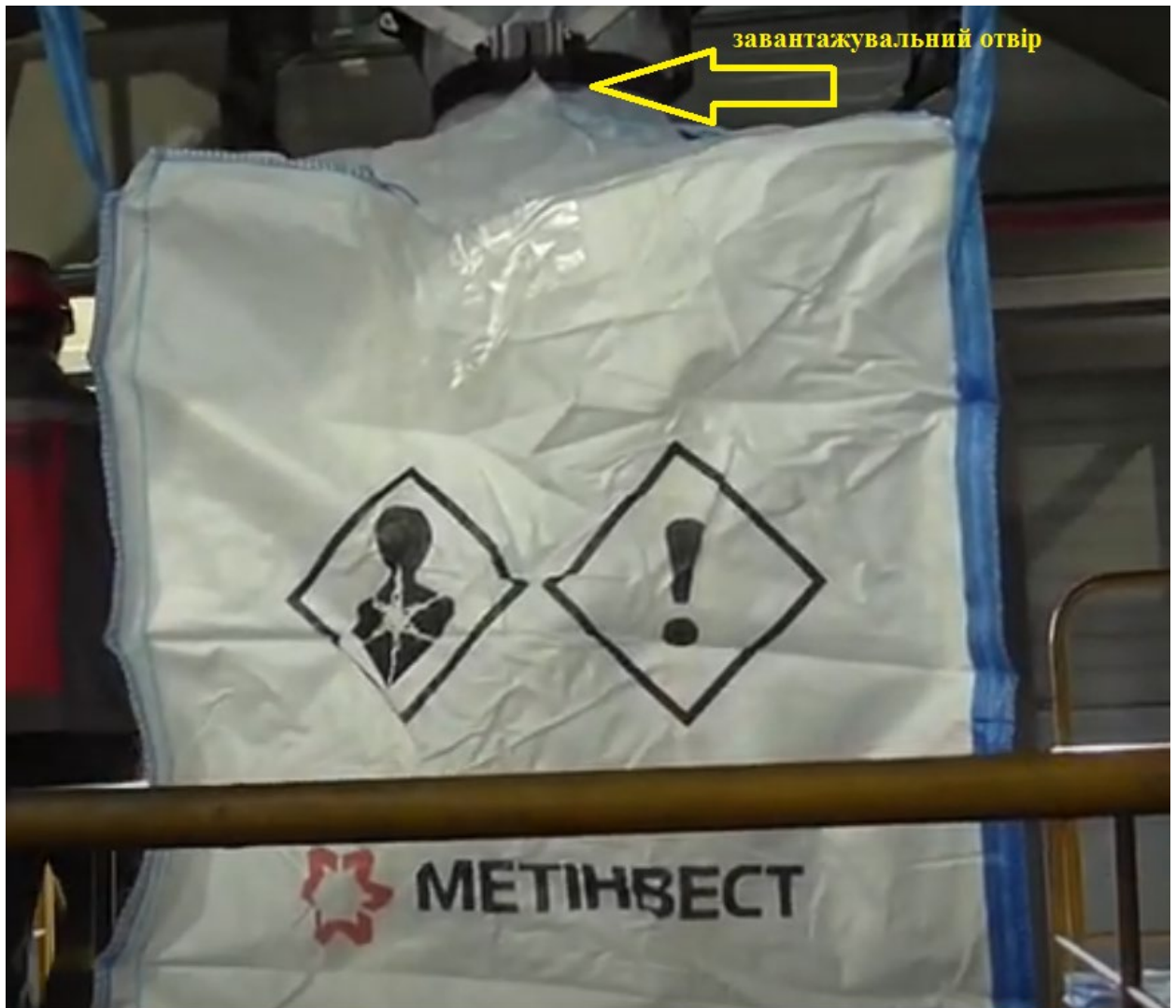
Рисунок 1.1 - Процес завантаження гранульованого пеку у біг-беги
