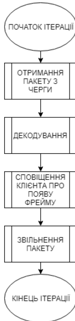
Рисунок 3.3 – Схема ітерації алгоритму декодування у програмному забезпеченні для відтворення відеофайлів
