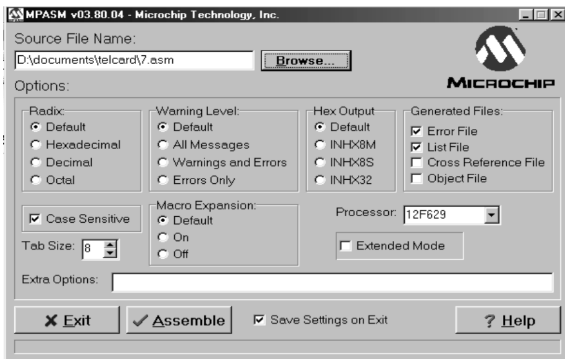
Рисунок 3.5 – Компілятор асемблерного коду вбудований в симулятор MPLAB
