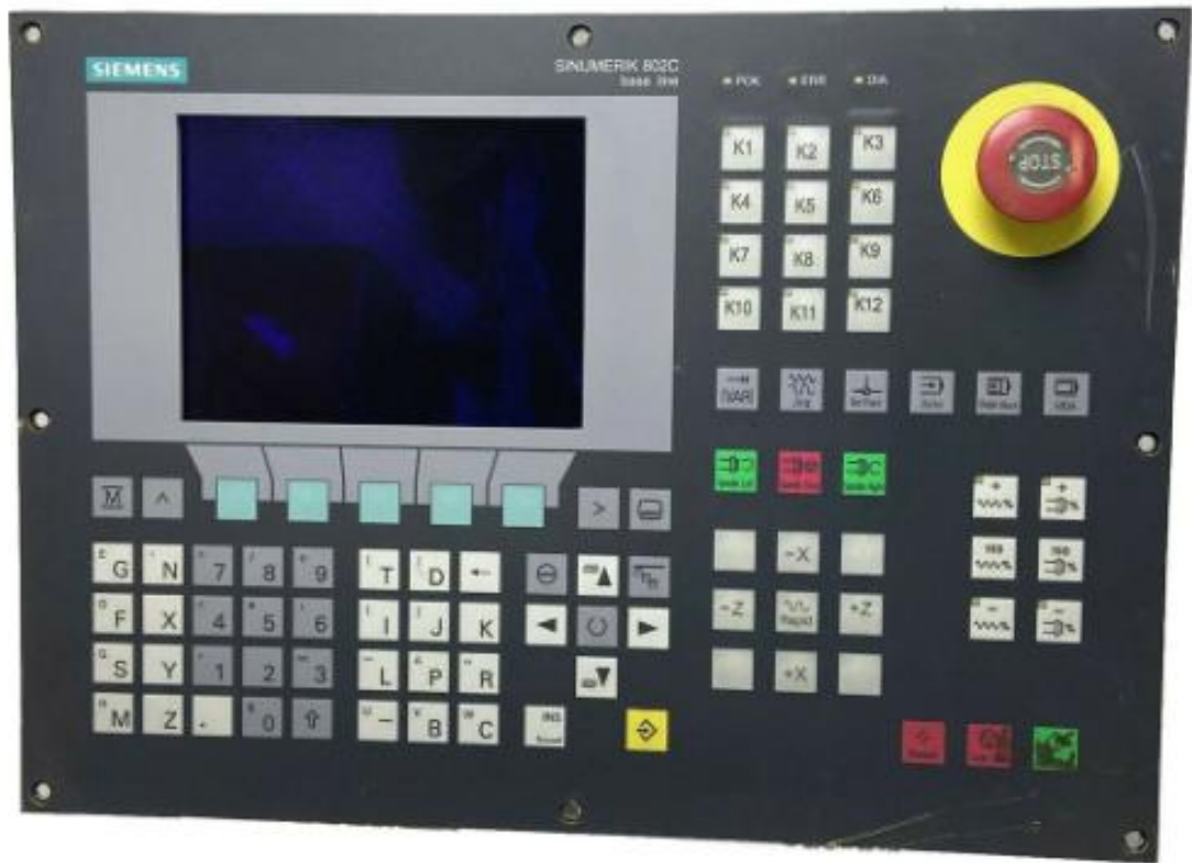
Рисунок 1.2 – Система ЧПУ SINUMERIK 802C Base Line
