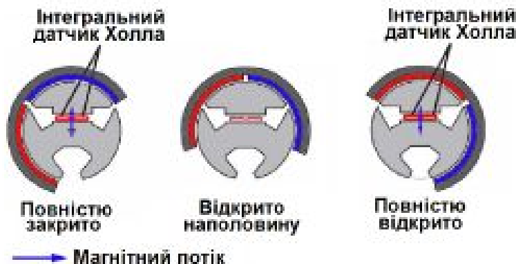
Рисунок 2.5 – Принцип роботи ДПДЗ на ефекті Холла
