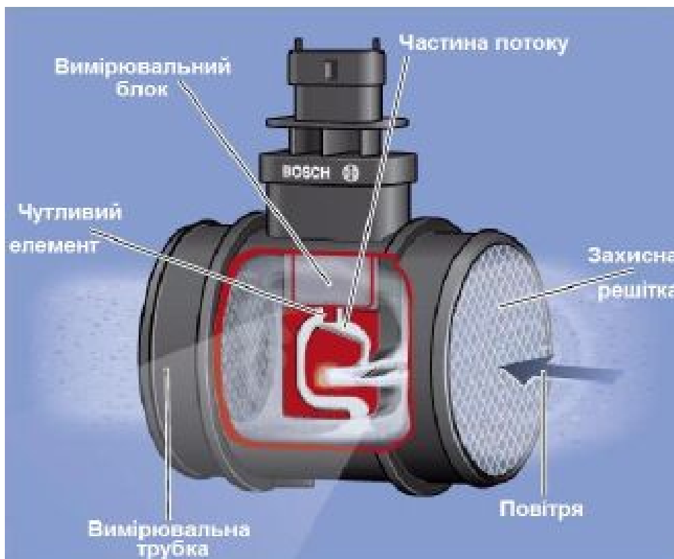
Рисунок 4.8 – Датчик масової витрати повітря з плівковим нагрівальним елементом
