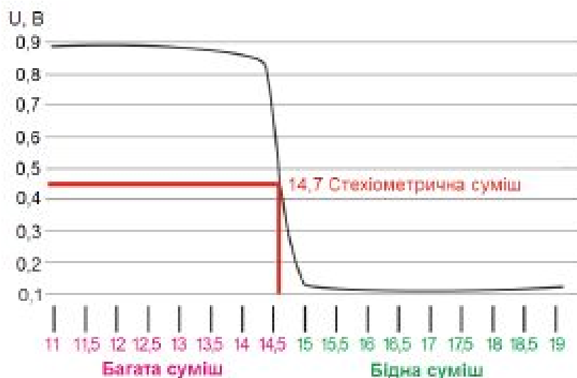
Рисунок 6.3 – Вихідний сигнал цирконієвого датчика кисню
