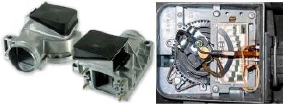
Рисунок 4.6 – Потенціометр датчика об'ємної витрати повітря виробництва BOSCH
