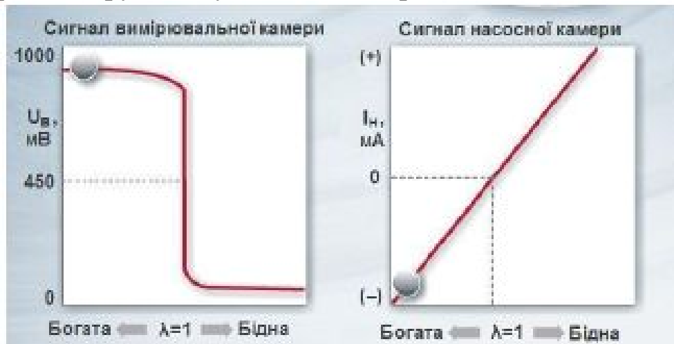
Рисунок 6.9 – Вихідний сигнал камери вимірювання та камери накачування ШДК
