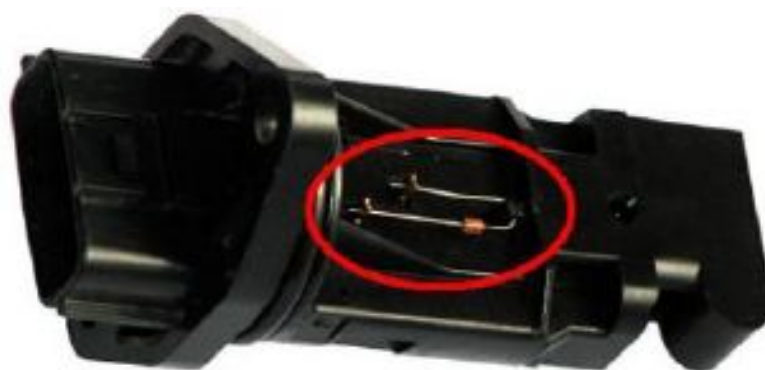
Рисунок 5.4 – Зовнішній вигляд датчика температури повітря в впускному тракті на основі PN-переходу
