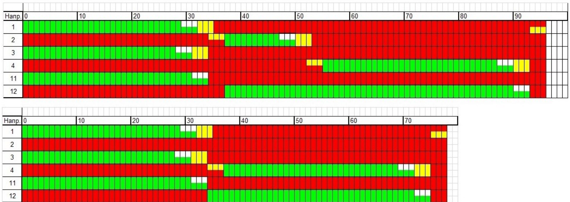
Рисунок 2. 7 – Циклограми світлофорного регулювання в координованому режимі на перехресті вулиць Говорухи та Культурної (без пропуску фази №2 та з пропуском фази №2)
