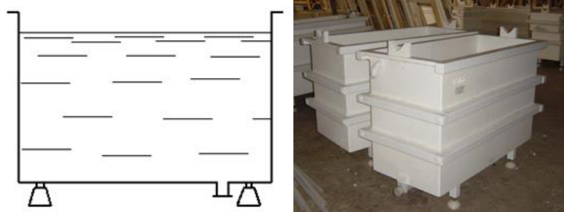
Рисунок 5.9 – Схема і загальний вигляд ванни для хімічного пасивування [23]
