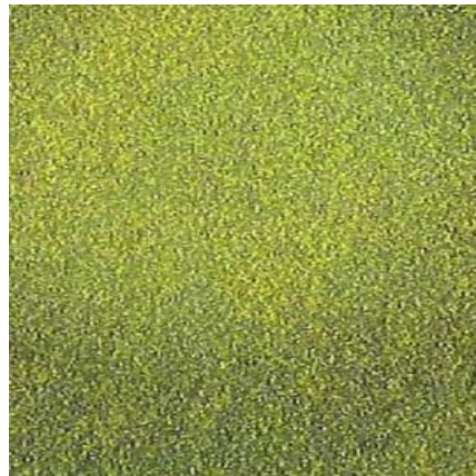
Рисунок 1.2 – Карбідна неоднорідність (1 бал) сталі P6M5, x100 [16]
