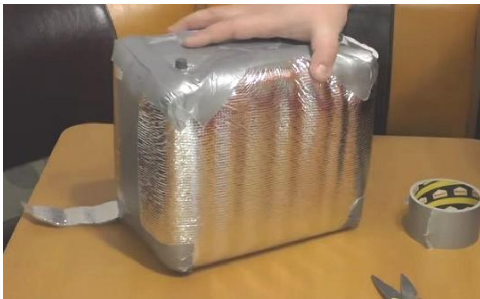
Рисунок 6.7 – Саморобний термокейс для АКБ
