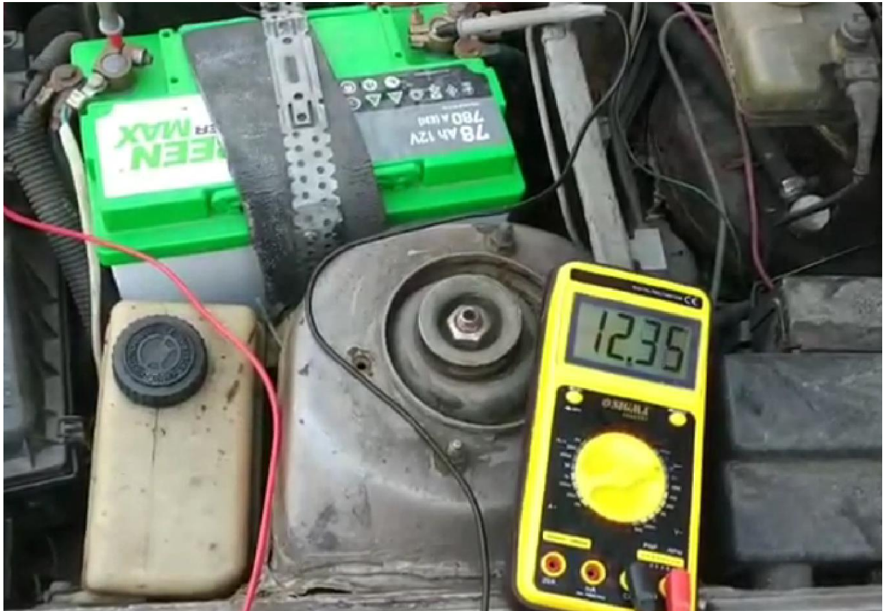
Рисунок 4.1 – Вимірювання напруги АКБ при холодному запуску двигуна під час досліду
