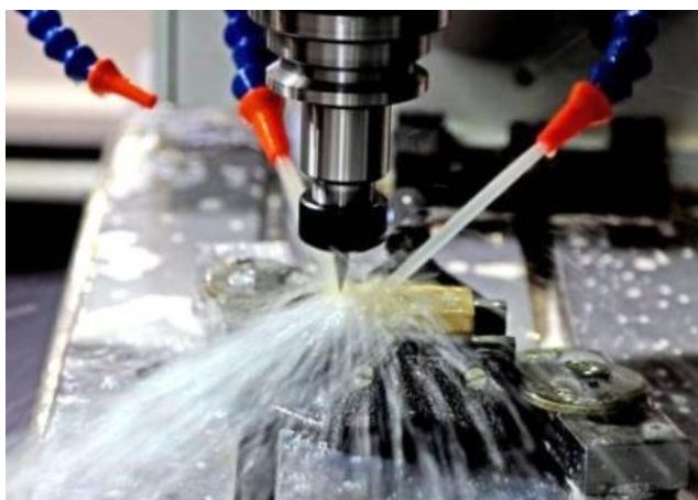
Рисунок 3.1 – Використання ЗОТС при обробці на верстаті
