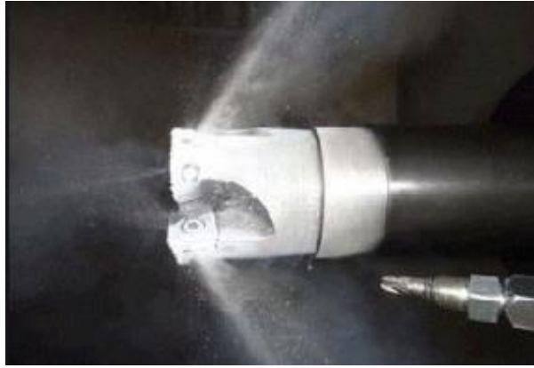
Рисунок 5.4 – Криогенне зміцнення поверхні
