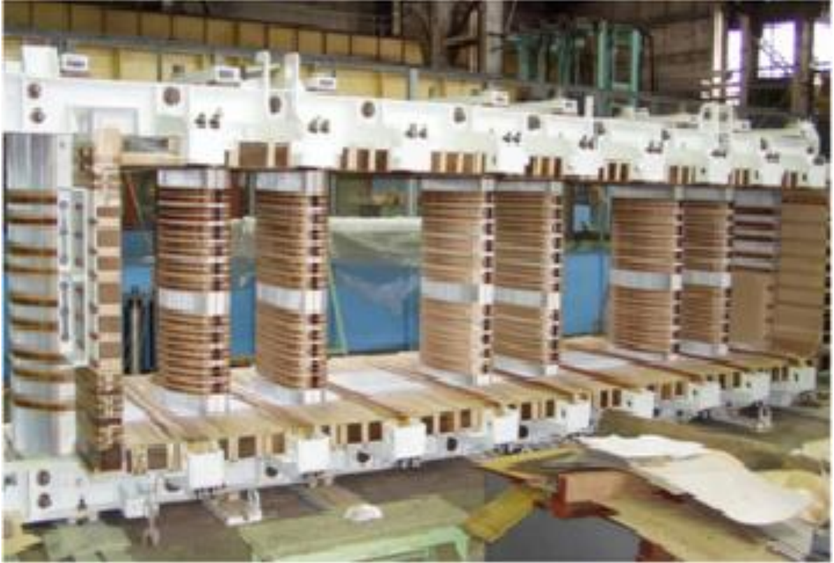
Рисунок 1.5 — Магнітна система трифазного КШР з підмагнічуванням [14]
