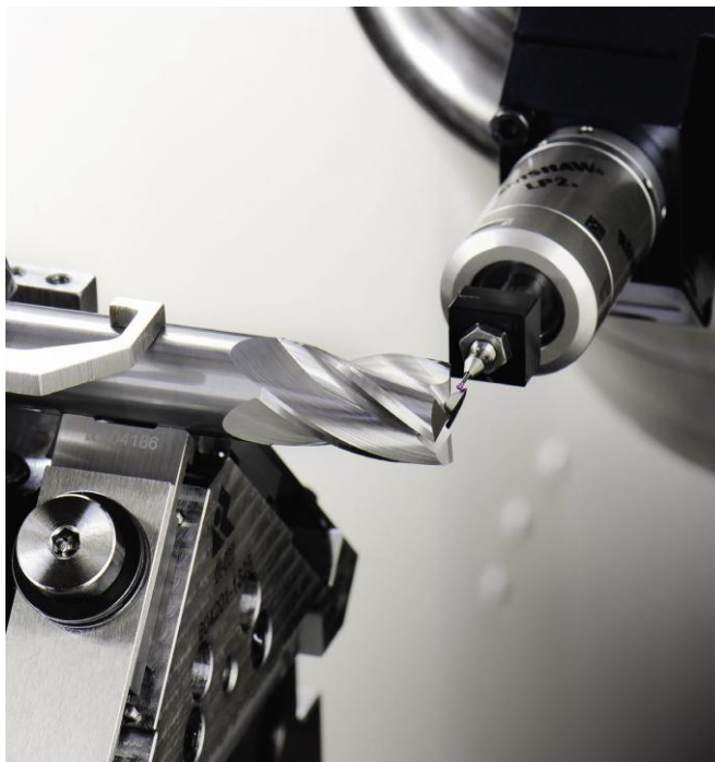
Рисунок 3.4 – Вимірювання геометричних розмірів, виготовленої кінцевої фрези, на верстаті GrindSmart®630XW
