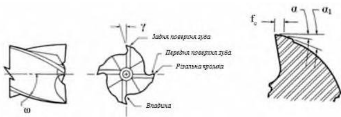
Рисунок 1.19 – Геометрія заточування кінцевої фрези [11]
