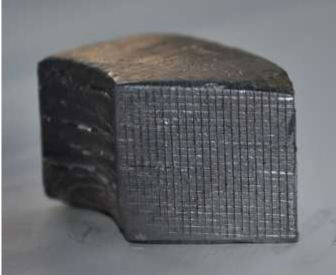
Рисунок 2.7 – Сегмент с нанесенной делительной сеткой.
