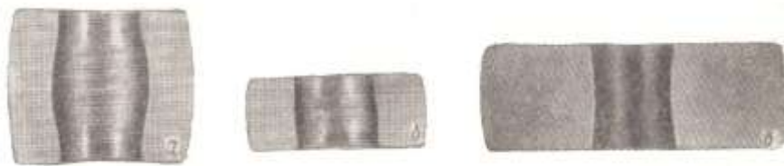
Рисунок 5.11 - Схема деформации полый толстостенной заготовки[92].
