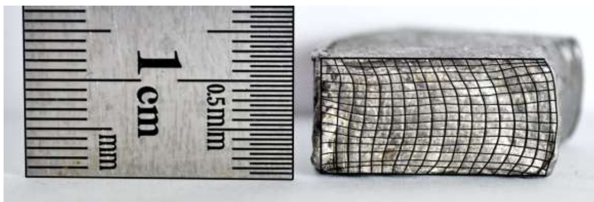
Рисунок 5.19 - Осадка с полным ограничением течения металла по наружной боковой поверхности.
