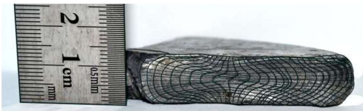
Рисунок 5.16 – Свободная осадка между двумя плоскими шероховатыми плитами.
