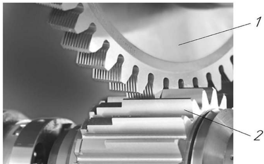
Рисунок 4.3 – Схема шевінгування зубчастого колеса
