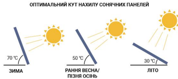
Рис. 10.1 - Оптимальне розташування панелей щодо горизонту Розрахунок куту нахилу та азимуту фотоелектричних (PV) панелей за допомогою калькулятора для м. Запоріжжя, Запорізька область, Україна.
