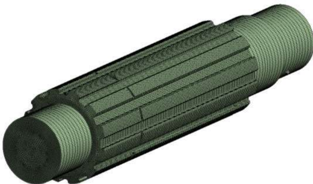
Рисунок 2.7 – Сітка кінцевих елементів розрахункової моделі валу
