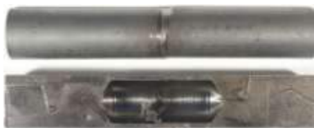
Рисунок 3.35 – Внешний вид типичного оболочкового образца.
