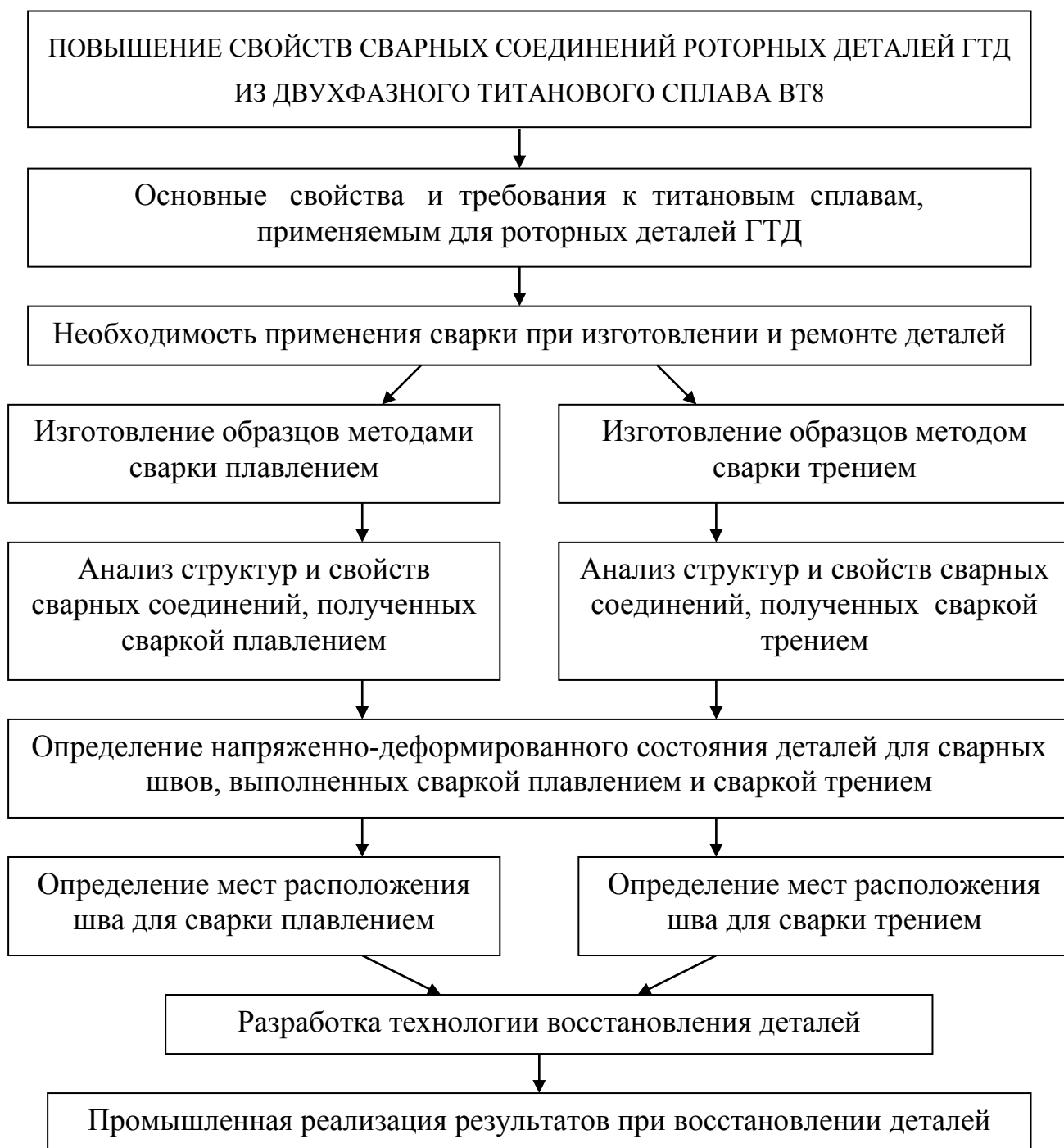
Рисунок 2.1 – Комплекс исследовательско-технологических мероприятий для повышения уровня свойств сварных соединений титановых сплавов.
