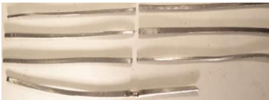
Рисунок 2.2 – Внешний вид присадочных прутков из материала ВТ8.
