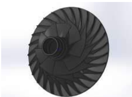
Рисунок 5.1 – Модель моноколеса центробежного компрессора.
