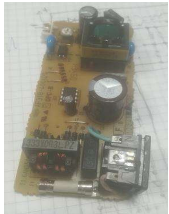
Рисунок 6.13 – Блок живлення для пристрою (19В / 1А)
