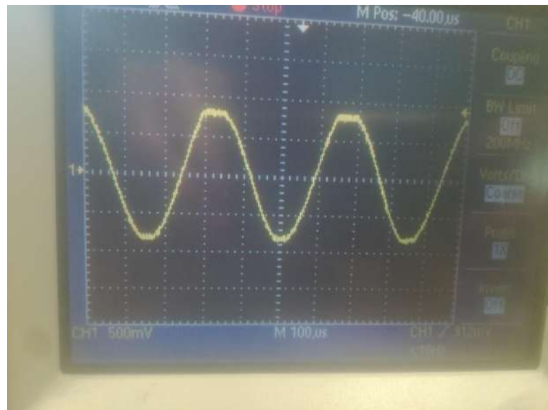
Рисунок 6.7 – Розбалансування моста Віна (підвищений рівень нелінійних спотворень внаслідок неточного встановлення коефіцієнту підсилення)
