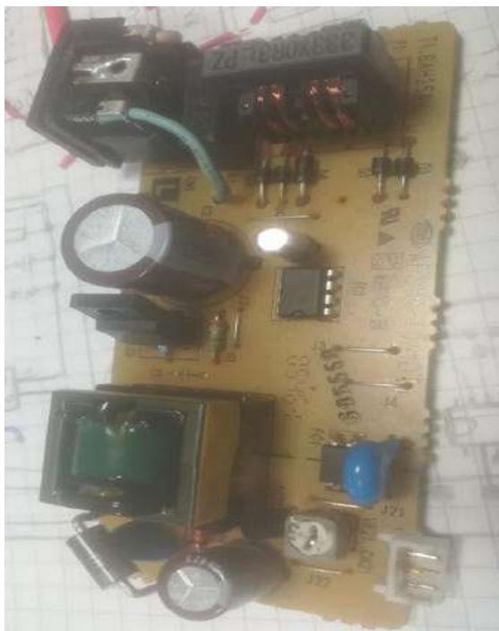
Рисунок 6.13 – Блок живлення для пристрою (19В / 1А)
