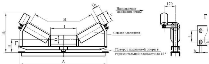
Рисунок 2.3 – Роликовая опора верхня, призначена для центрування стрічки
