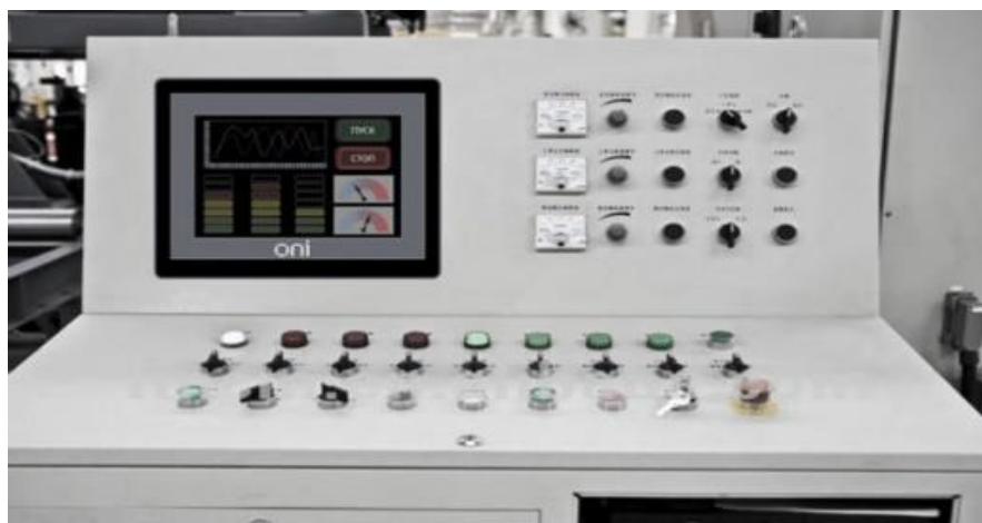
Рисунок 1.2 – Пульт управління на базі панелі оператора [5]
