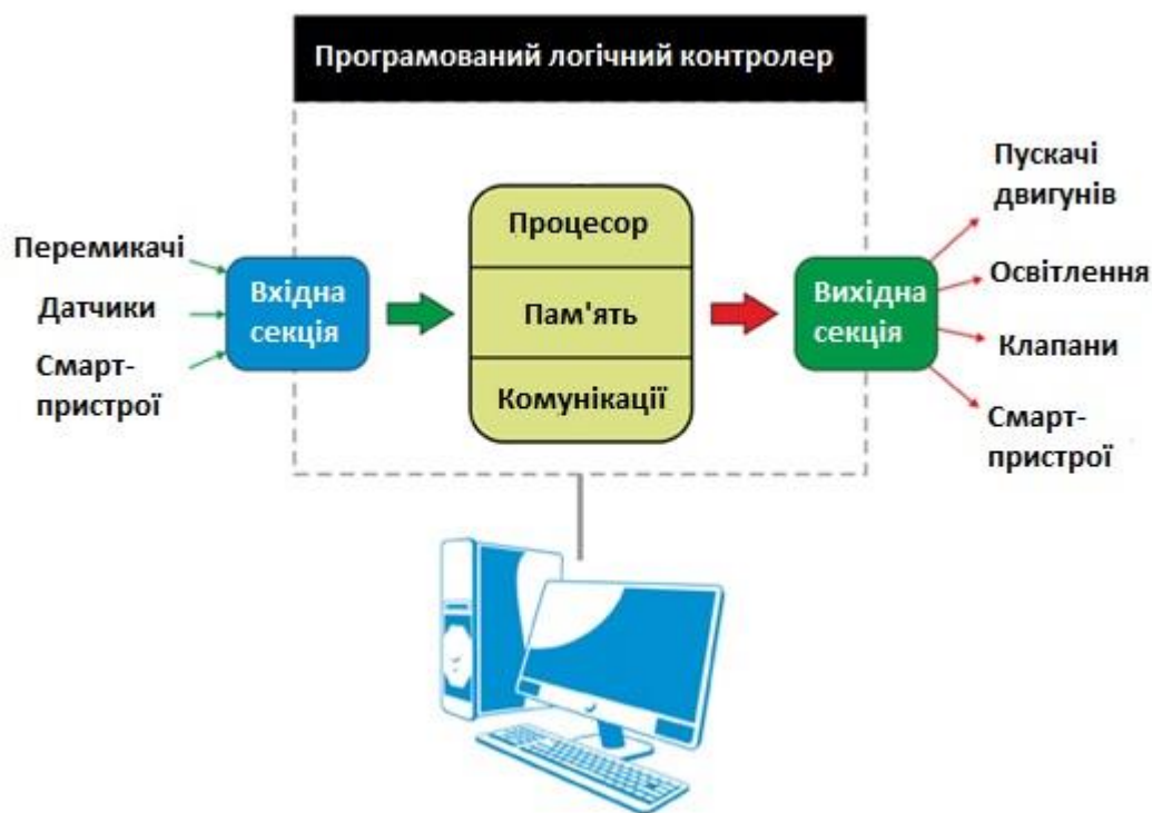
Рисунок 1.5 – Структура і принцип дії ПЛК
